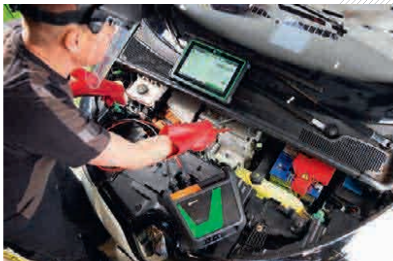
Das MT-HV und der mega macs X vernetzen sich kabellos via Bluetooth und decken alle messtechnischen Funktionen ab, die im Zusammenhang mit E- und Hybrid-Fahrzeugen benötigt werden.
